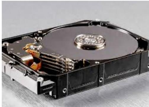
Un autre composant essentiel de l'ordinateur est le disque dur. Ce dernier permet de stocker les fichiers d'une manière permanente. Il existe 3 grandes familles de disques durs : Les disques durs avec un branchement IDE, les disques dur avec un branchement Sata, et les disques durs avec un branchement SSD. Ces derniers permettent de sauvegarder les informations plus rapidement mais ils sont plus fragiles.
